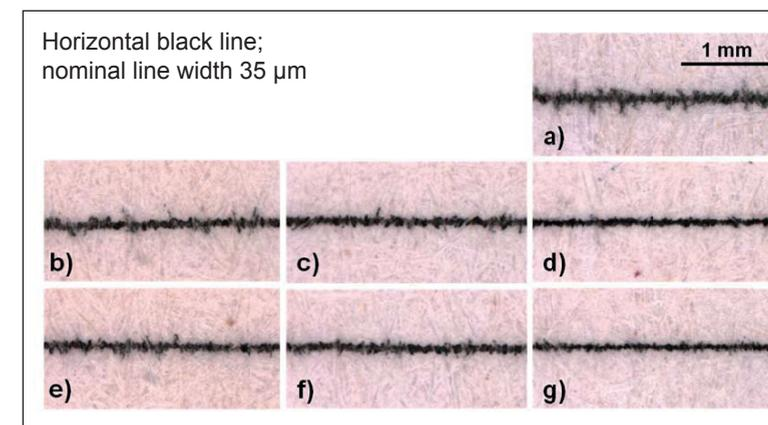
Figure 10: Optical micrographs of horizontal black lines: a) UT, b) OX-SG, c) OX-SGC, d) OX-SGSi, e) HM-SG, f) HM-SGC and g) HM-SGSi.
